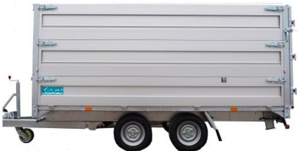
Doppelte AluMate500 Aufsatzbordwände (H=2x 50 cm)
