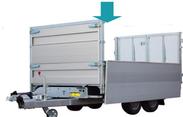
AluMate800 Aufsatzbordwände (H= 80 cm)
