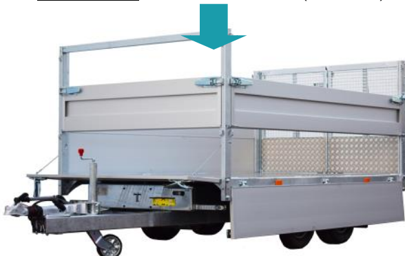
AluMate400 Aufsatzbordwände (H= 40 cm)
