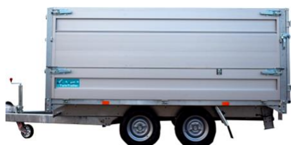
AluMate800 Aufsatzbordwände (H= 80 cm)
