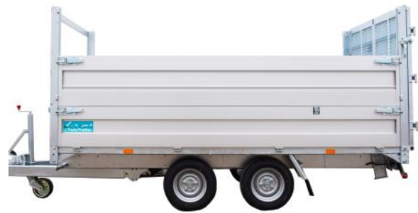
Einzelne AluMate500 Aufsatzbordwände (H= 50 cm)
