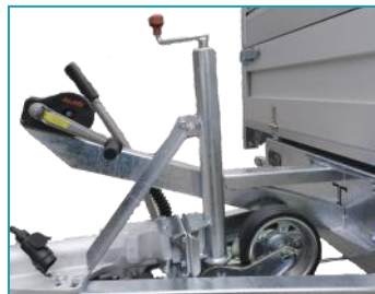
Manuelle Seilwinde mit Stütze
