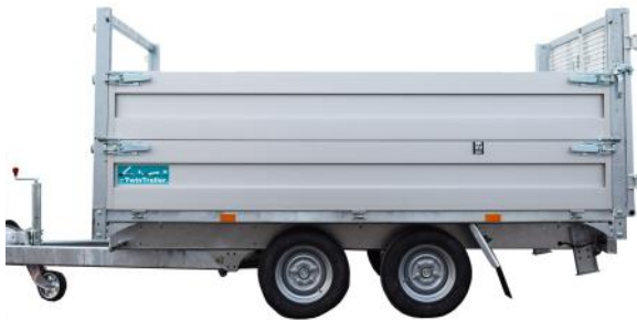
AluMate400 Aufsatzbordwände (H= 40 cm)
